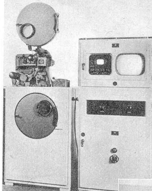
Filmabtasteinrichtung der Fernseh GmbH, Darmstadt; links Filmabtaster, rechts Verstärker-einheit und Kontrollempfänger. Rechtes Foto Abtaströhre mit einem 9-cm-Schirmdurchmesser
