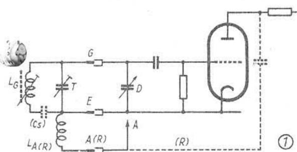
Abb. 1. Je Schwingkreis werden 3 Kontakte G, E, A für Gitter-, Erd- und Antennen- bzw. Rückkopplungsanschluß benötigt
