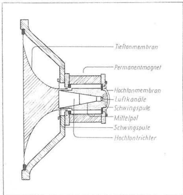
Abb. 1. Schnitt durch den „Dual-Concentric“-Lautsprecher, bei dem der Tiefenkonus eine Fortsetzung des rückwärtigen Hochtontrichters bildet
