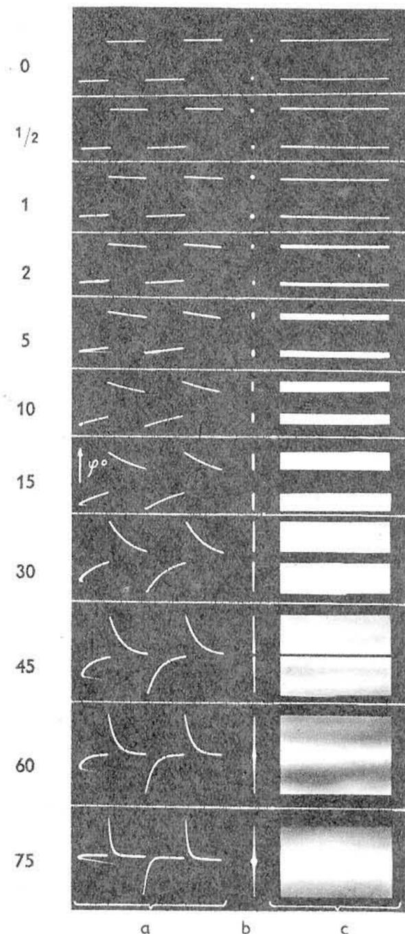
Abb. 29. Oszillogramme zur Phasenmessung mit Rechteckspannungen. a) Bilder zweier Perioden, b) ohne Zeitablenkspannung, c) Zeitablenkfrequenz größer als Meßfrequenz und nicht synchronisiert
