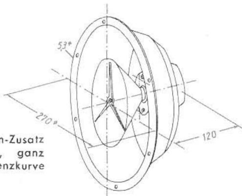
Abb. 6. Hochton-Zusatz von Widmann, ganz rechts Frequenzkurve
