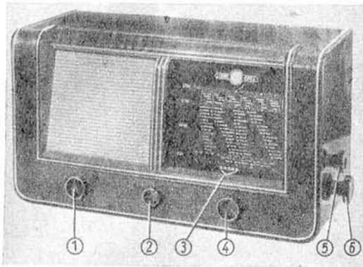
① Lautstärkeregl. (Drehen), Netzschalter (Druck-Zug), ② Klangblende (Drehen), Breitbandschalter (Druck-Zug), ③ Wellenbereichsanzeige, ④ Senderabstimmung, ⑤ Kurzwellenupe, ⑥ Bereichsschalter
