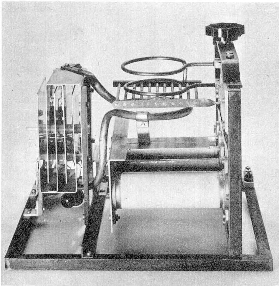
Abb. 5. Hochfrequenzteil des Diathermiegerätes. Rechts unten Kondensator  $C_1$ , darüber die Koppelspulen  $L_1$  und  $L_2$ ; zwischen beiden ist das kompakte Faradaysche Gitter angebracht. Die Spule  $L_2$  ist mit Hilfe des großen Drehknopfes ausschwenkbar
