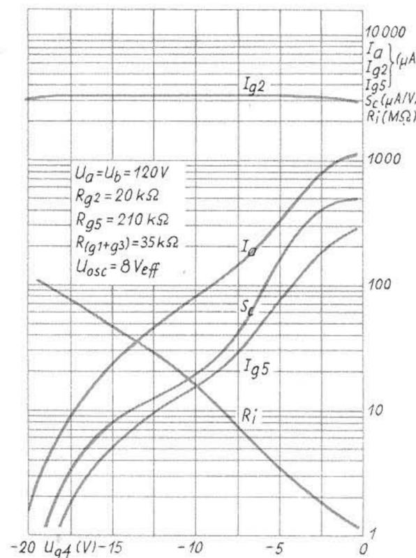
$I_a$ ,  $I_{g2}$ ,  $I_{g5}$ ,  $S_c$  und  $R_i$  der DK 40 in Abhängigkeit von der Gittervorspannung des Pentodenteiles
