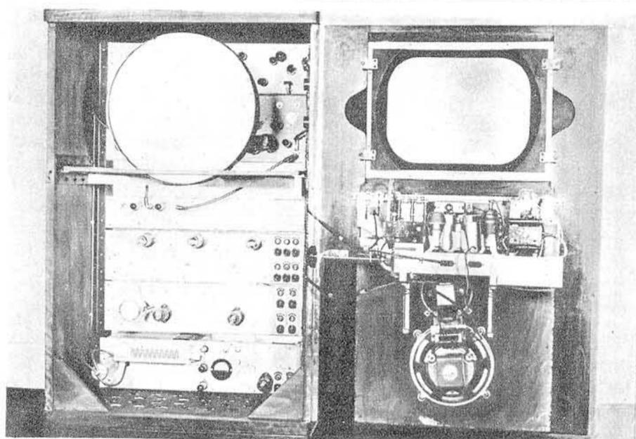
Fernseh-Standempfänger, Schranktür geöffnet, links ist die 40-cm-Bildröhre sichtbar und rechts oberhalb der beiden Lautsprecher der Tonteil
