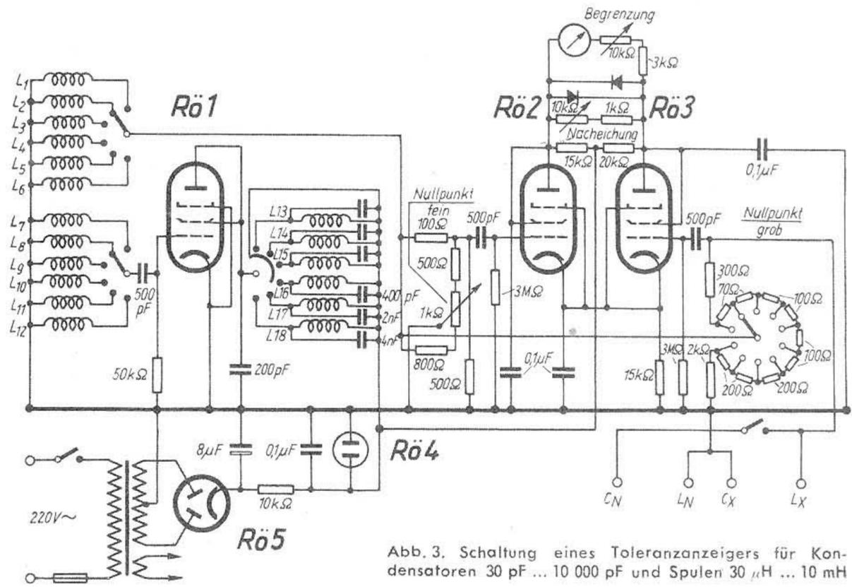
Abb. 3. Schaltung eines Toleranzanzeigers für Kondensatoren 30 pF ... 10 000 pF und Spulen 30  $\mu$ H ... 10 mH
