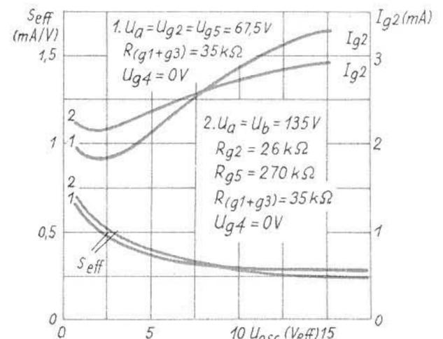
Anodenstrom der Triode und effektive Steilheit in Abhängigkeit von der Oszillator-Schwingspannung
