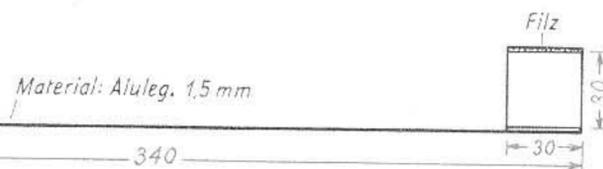
Abb. 4. Stativ für Bildröhre MW 31/16
