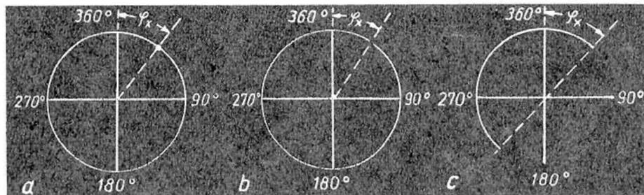
(Abb. 5) geschaltet wird. Die Ausgangslage am Umfang des Leuchtschirmes kann durch phasendrehende Glieder am Eingang der Impulsschaltung wunschgemäß berichtigt werden. Der Abstand der Meßmarke von der Nullmarke gibt am Kreisumfang den Phasenunterschied direkt in Winkelgraden (max.  $360^\circ$ ) an.
