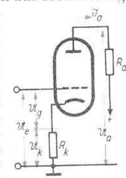
Abb. 5. Anwendung der Stromgegenkopplung
