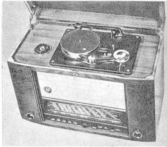
lich den Aufsprech- und Wiedergabeverstärker für den Drahtrecorder, bestückt mit 2x EF 12 k, EF 14, EL 11 und EM 71. Der zuletzt genannte „Magische Fächer“ dient als Aussteuerungsanzeiger für die Aufnahme.
