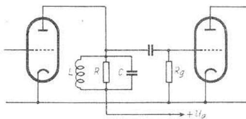
Abb. 1. Breitbandverstärkerstufe mit gedämpftem Resonanzkreis.
