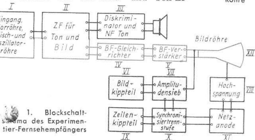
1. Blockschemata des Experimentier-Fernsehempfängers
