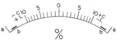
Abb. 2. Skalenbeispiel des Toleranzanzeigers, a) mechanische Anschläge, b) Endausschlag
