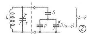
Abb. 2. Zweckmäßige Ausführung einer Bandspreizung für Kurzwellen
