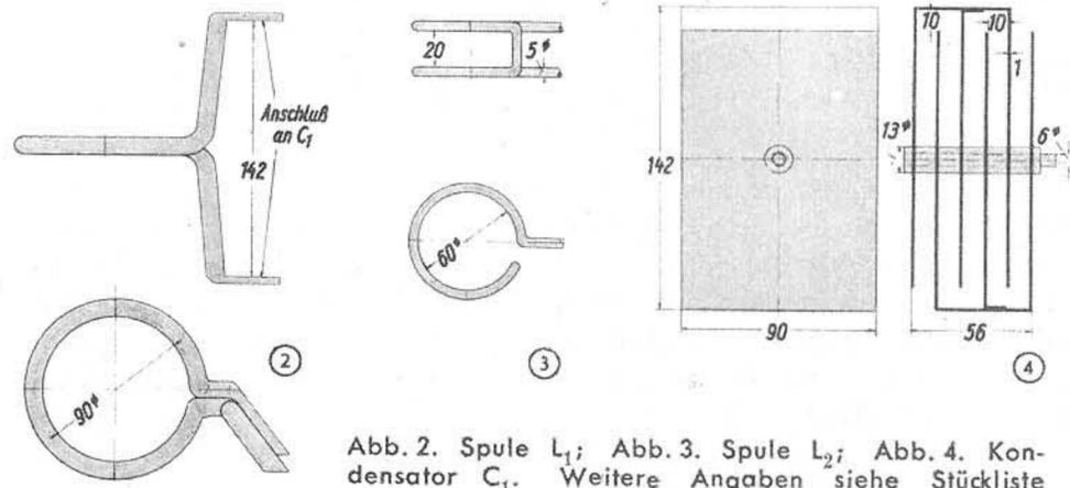
Abb. 2. Spule  $L_1$ ; Abb. 3. Spule  $L_2$ ; Abb. 4. Kondensator  $C_1$ . Weitere Angaben siehe Stückliste
