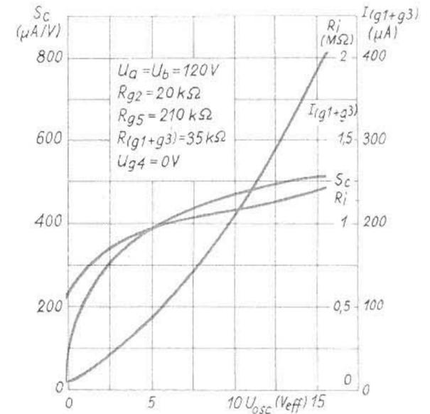
$I_{(g1+g3)}$ ,  $S_c$  und  $R_i$  in Abhängigkeit von der Oszillator-Schwingspannung
