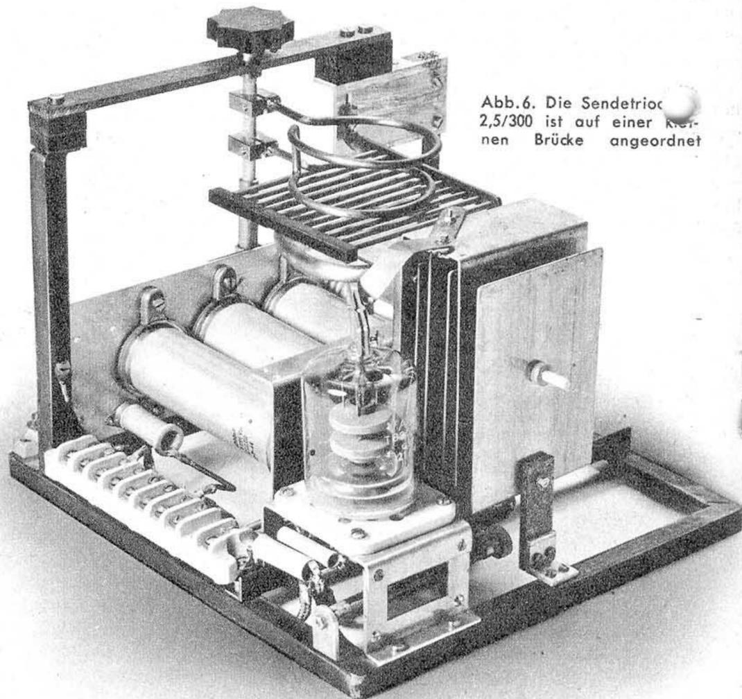
Abb. 6. Die Sendetriode 2,5/300 ist auf einer keramischen Brücke angeordnet
