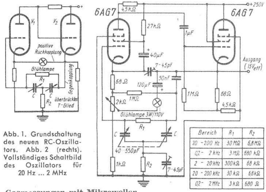
Abb. 1. Grundschiung des neuen RC-Oszillators. Abb. 2 (rechts). Vollständiges Schaltbild des Oszillators für 20 Hz ... 2 MHz
