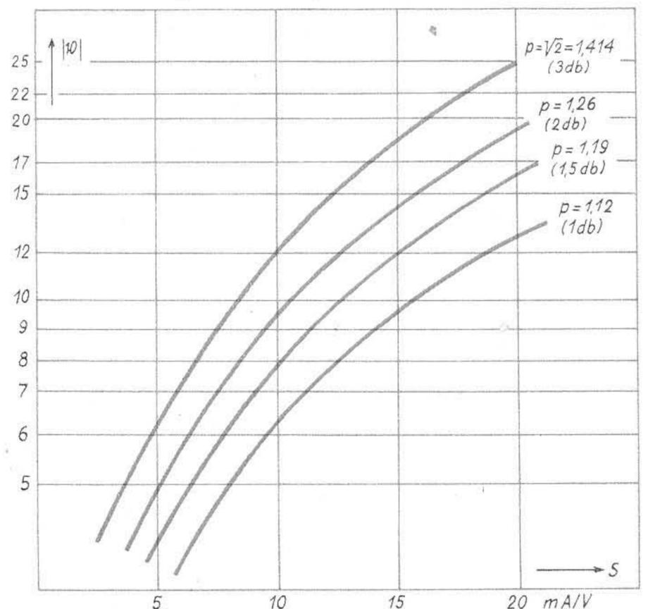
Abb. 2 (links). Resultierender Widerstand  $R_p$  in Abhängigkeit von der Gesamtkapazität  $C_p$ ; Bandbreite  $2\Delta\omega = 45 \cdot 10^6$ . Abb. 3. Verstärkung in einer Stufe als Funktion der Röhrensteilheit für  $C_p = 17,5$  pF
