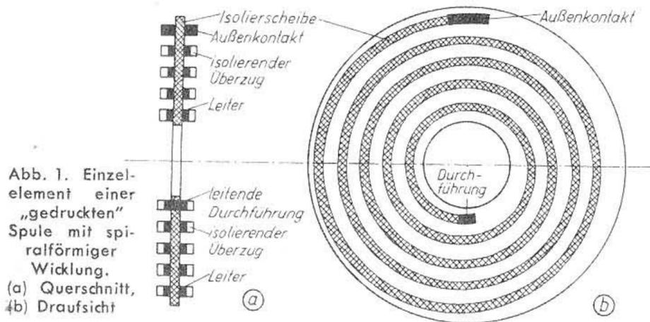
Abb. 1. Einzelelement einer „gedruckten“ Spule mit spiralförmiger Wicklung.
